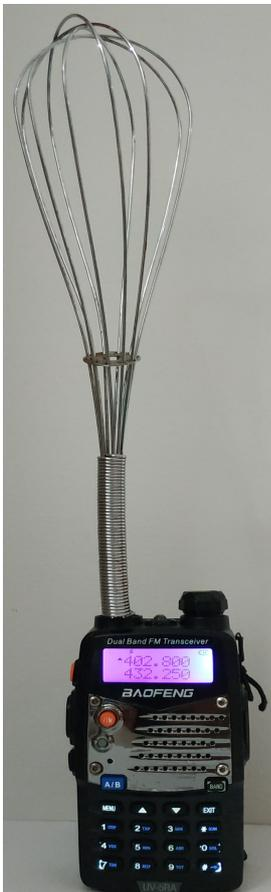
La teoria vorrebbe un BAL-UN 1:1 per l'interfaccia "antenna/linea di trasmissione" ma, a volte, la pratica prevale.
