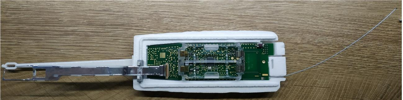
*Interno di una radiosonda: si può notare l'alloggiamento delle batterie che sono state rimosse*
