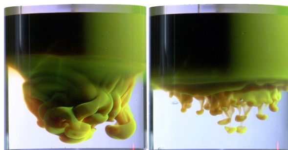
Esempio di instabilità di Rayleigh-Taylor. Matthew M. Scase, Kyle A. Baldwin, Richard J. A. Hill (doi: 10,3791/55088)
